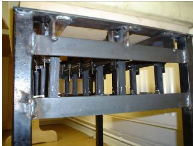
Detailansicht mit eingeschraubten Schiebepotentiometern
